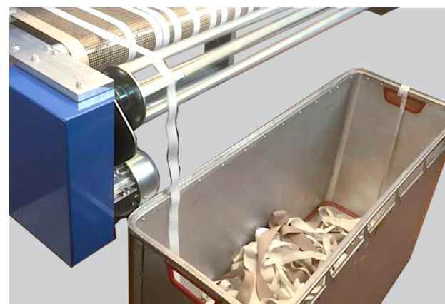
USCITA FORNO CON SBATTITORE OVEN EXIT WITH BEATER
