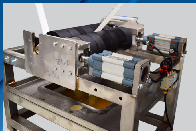
STAZIONE DI FOULARD, CON PISTONI PER REGOLARE IL QUANTITATIVO DI PRODOTTO. FOULARD STATION, WITH PNEUMATIC PISTONS TO REGULATE THE QUANTITY OF PRODUCT.
